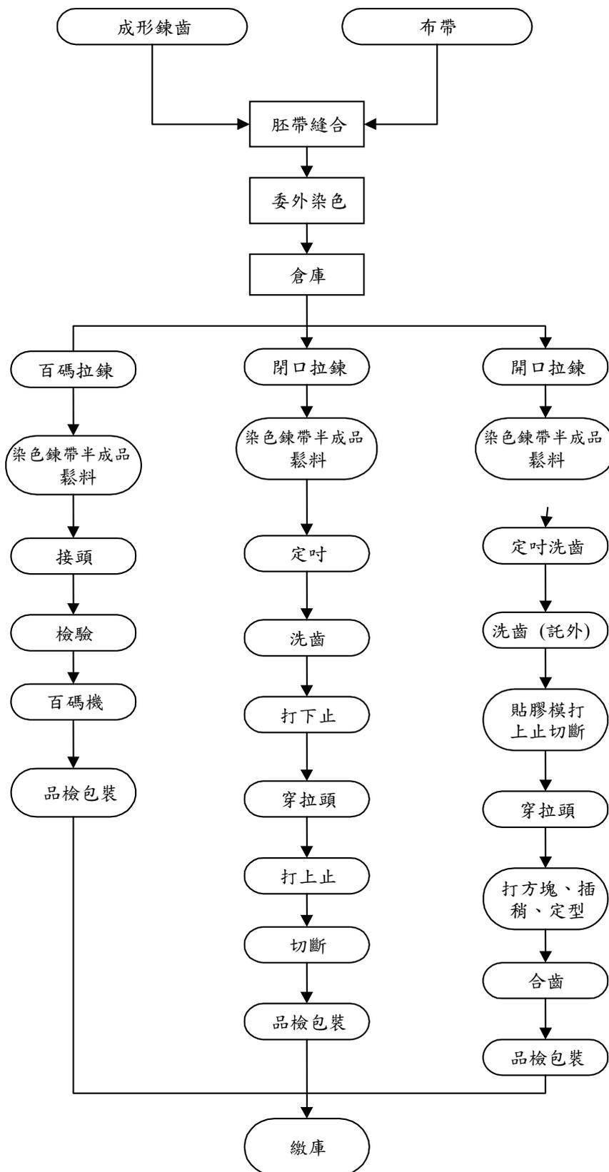
(2) 塑鋼製造流程
